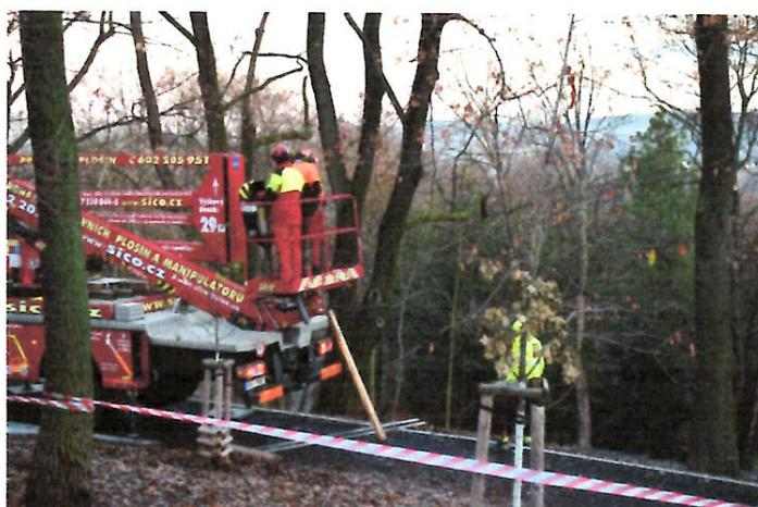
**Operátor plošiny navádí vysokozdvížnou plošinu ke kácenému stromu podle pokynů dřevorubce**
